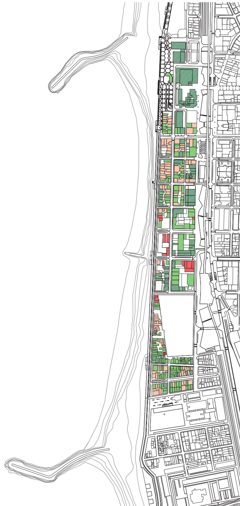
Fig. 1. Mapa de estado de conservação do edificado.
