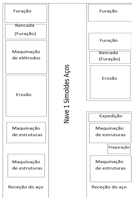
Figura 20 - Figura esquemática da nave 1 da Simoldes Aços
