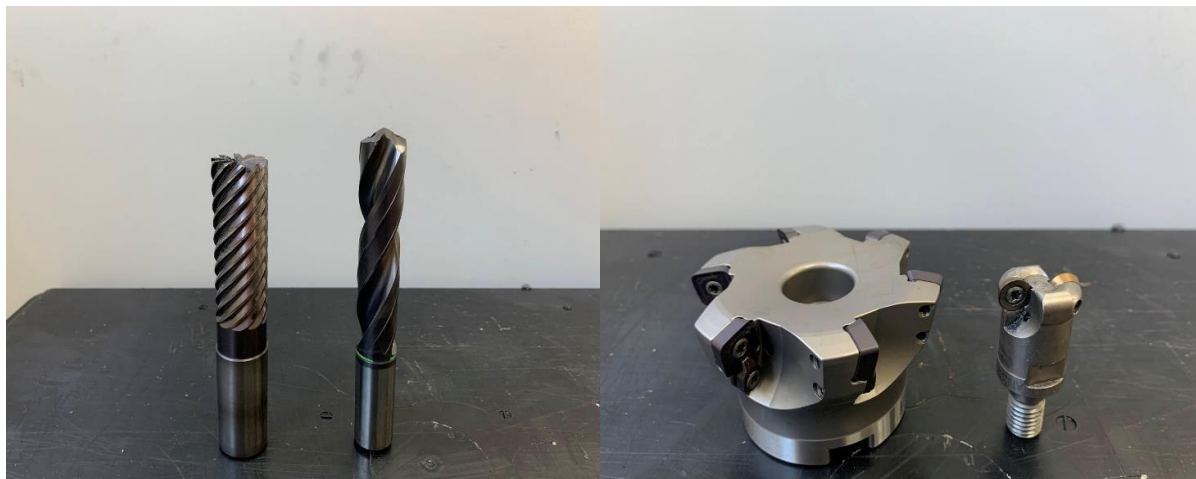
Figura 7 - Ferramentas inteiriças à esquerda e ferramentas de pastilhas à direita
