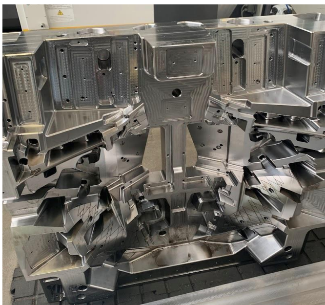
Figura 14- Cavidade de um Molde Metálico
