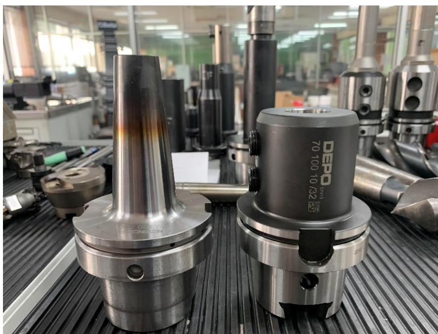
Figura 9 - Cone térmico (à esquerda) e cone Weldon (à direita)
