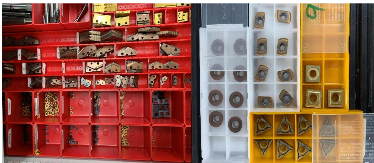
Figura 8 - Diferentes tipos de pastilhas presentes na ferramentaria da Simoldes Aç
