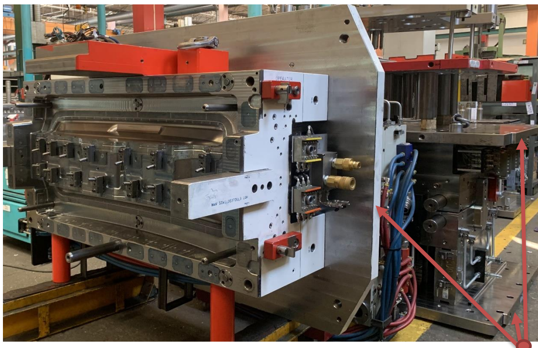
Figura 5 - Placas Estruturais assembladas ao respetivo molde; foto tirada pelo autor
