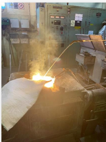
Figura 17 - Processo adotado para a avaliação do grau de desoxigenação do banho metálico.
