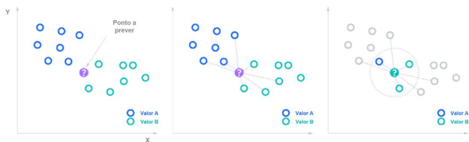
Figura 8 - Metodologia de previsão num algoritmo KNN (adaptado de [51]).
