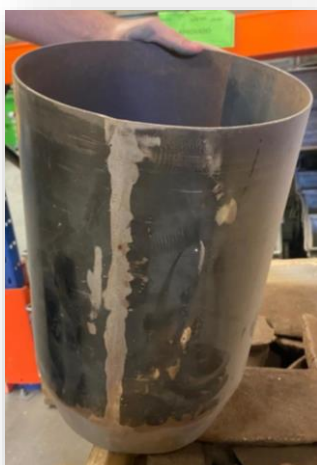
Figura 3 - Forma metálica utilizada na preparação do revestimento refratário dos FIC.
