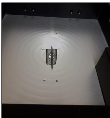
Fig. 03: Peça de cobre a ser submetida à análise por FRX.
