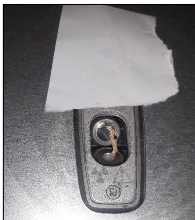
Fig. 01: Peça de ouro a ser submetida à análise por FRX.
