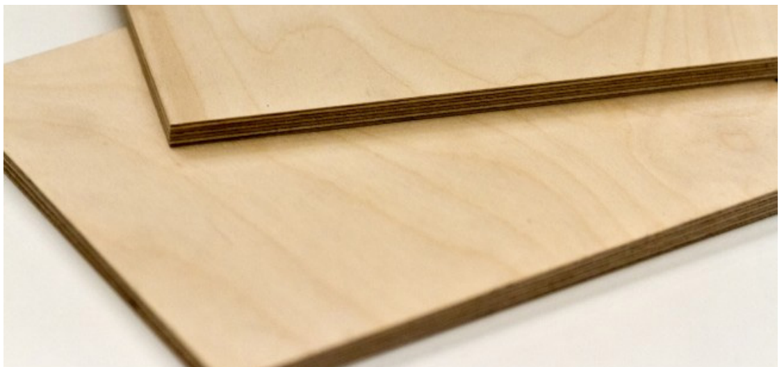
Figura 83 – Contraplacado revestido com folha de madeira
