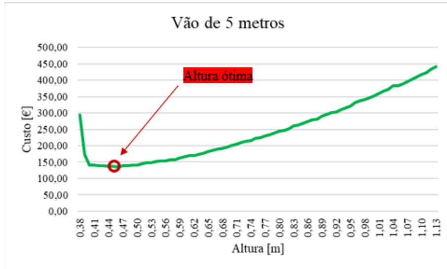
Figura 42 - Gráfico - Altura x Custo - Variando a altura a cada 1 cm para um vão de 5 metros – Exemplo 01
