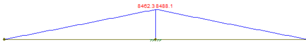
Figura 33 - Momento fletor obtido através do software Ftool para o carregamento da carlinga do exemplo 03
