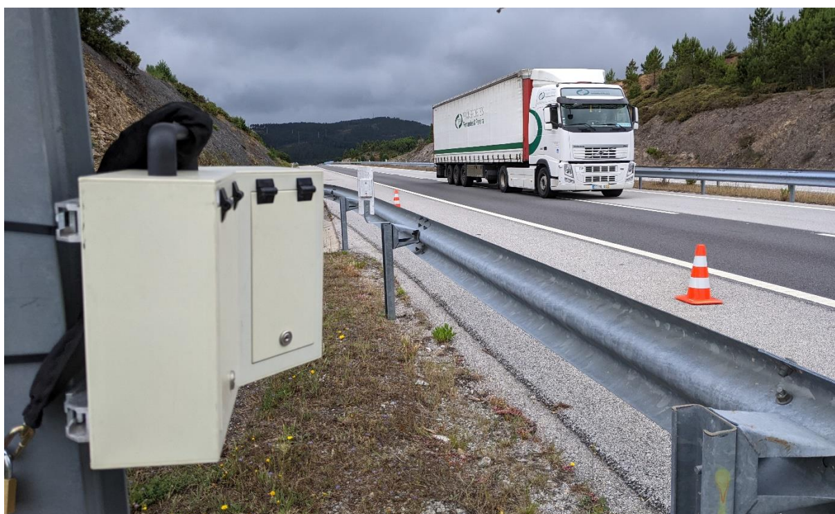
Fig. 13 – Radar modelo Viacount II posicionado no PK 96 da autoestrada A7 para recolher dados de tráfego.
