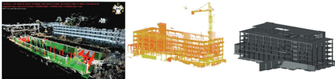
Fig. 2.16 - O progresso é mostrado nos modelos as-built e 4D BIM com o estatuto de código de cores sobreposto (esquerda), modelo as-built digitalizado a laser (meio) e 4D BIM modelo (direita) (Sawhney et al. , 2020)
