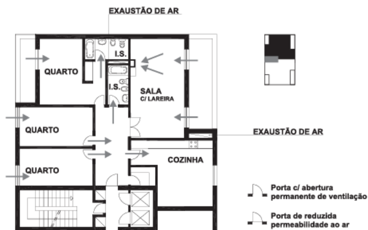
Figura 10 - Exemplo esquemático de dois sectores separados de ventilação numa habitação com lareira de fogo aberto [19]
