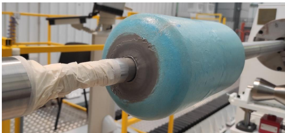
Figure 83 - Mandrel with a thin layer of Araldite® AV 138 M-1 adhesive.
