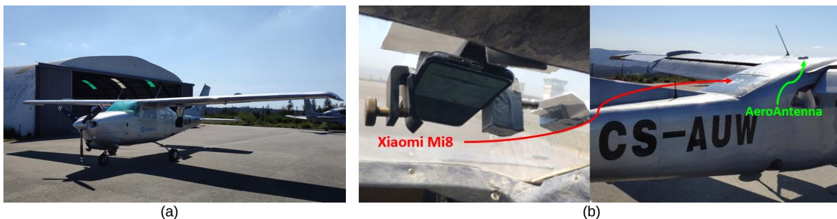
Figura 5.12 – Avião CESSNA C210 (a), localização do smartphone e antena aérea (b).
