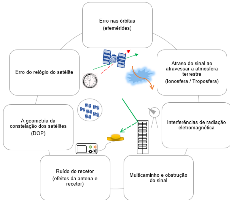
Figura 3.4 – Erros típicos que influenciam a precisão das medidas GNSS.
