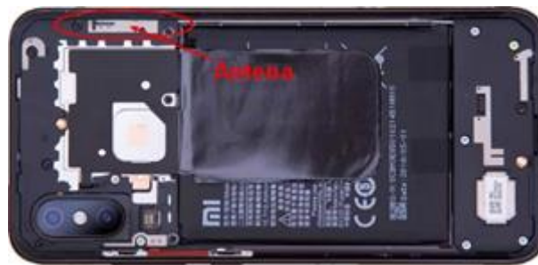
Figura 4.1 – Localização da Antena do smartphone Xiaomi Mi8.
