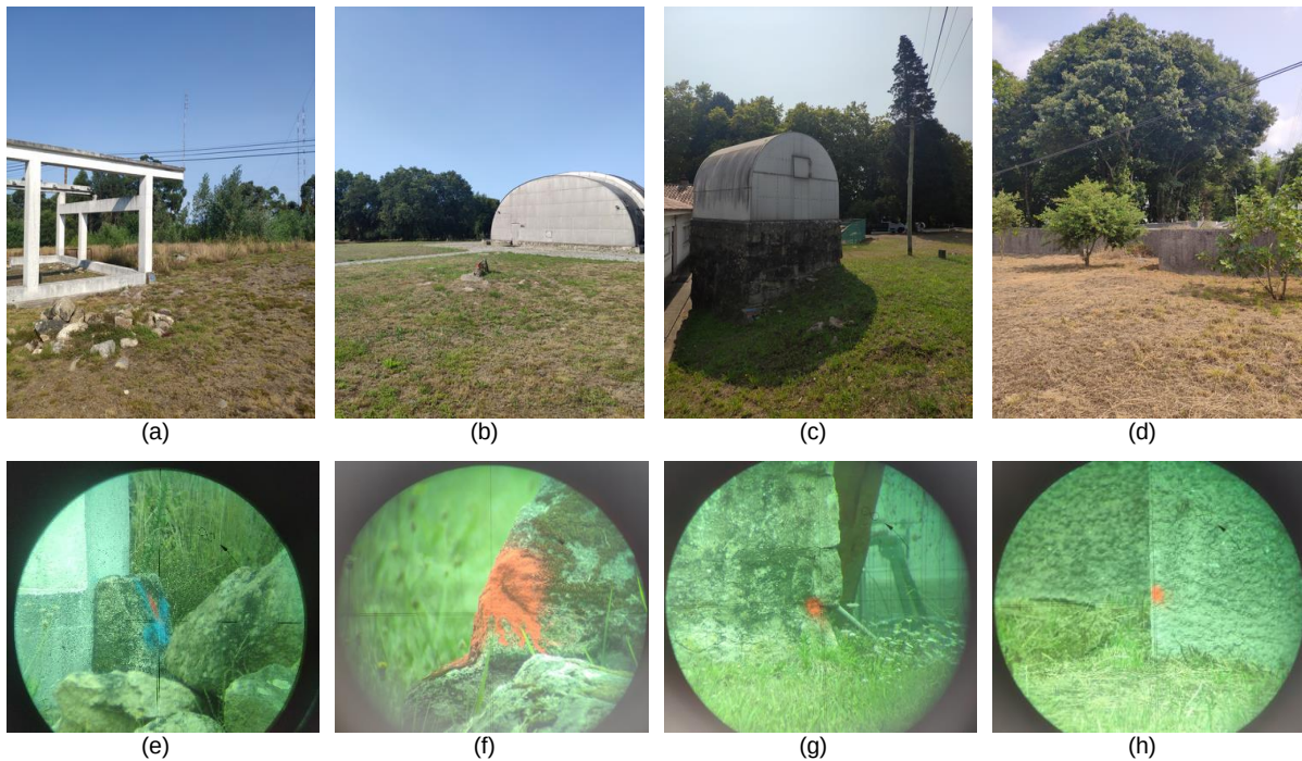
Figura 5.7 – Marco 1: (a) foto smartphone, (e) visada taqueómetro; Marca-rocha 4: (b) foto smartphone, (f) visada taqueómetro; Marca-construção 8: (c) foto smartphone, (g) visada taqueómetro; Marca-muro 13: (d) foto smartphone, (h) visada taqueómetro.
