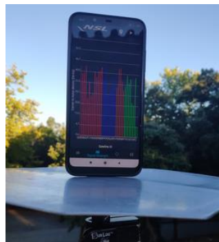
Figura 4.3 – Base metálica por baixo do smartphone para minimizar as reflexões.
