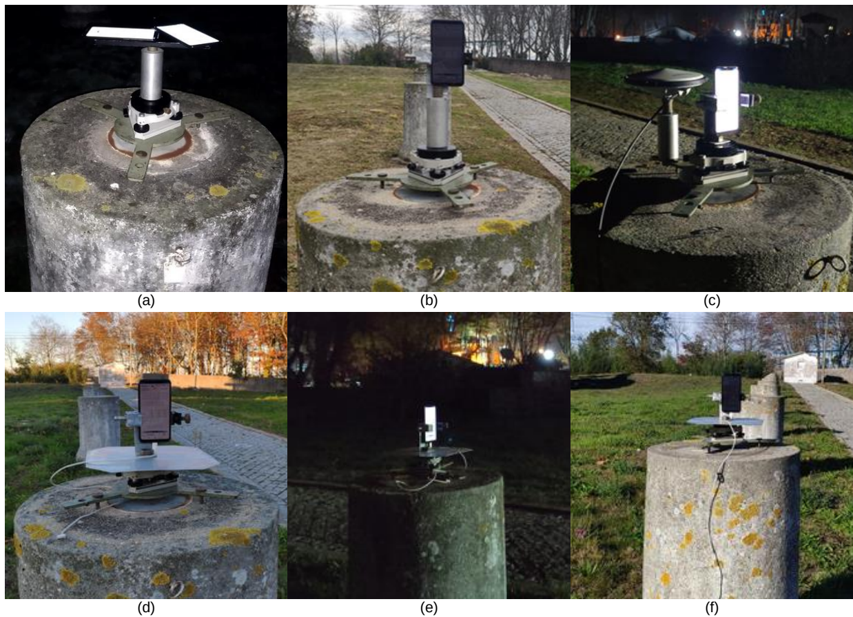
Figura 5.9 – Observações realizadas nos pilares da base de calibração do OAUP.
