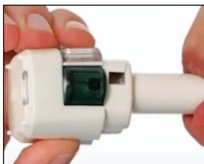
Figura 2 - Sensor acoplado à base do inalador.
