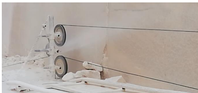
Figura 37. O fio com diamantes refrescados com água contínua.
