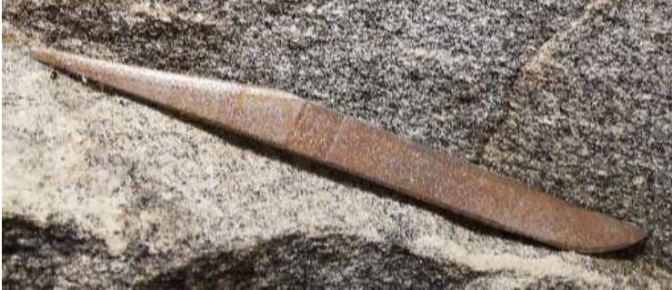
Figura 46. “Bico de aço” quebrado da lâmina do tear.
