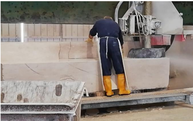
Figura 36. Talha-bloco: ruído, umidade, sobrecarga e repetitividade.
