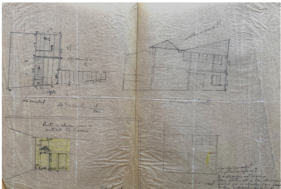
Desenho de estudo do projecto do encerramento da varanda e primeira instalação sanitária. Planta, alçado, perspectiva e corte. Cerca de 1973
