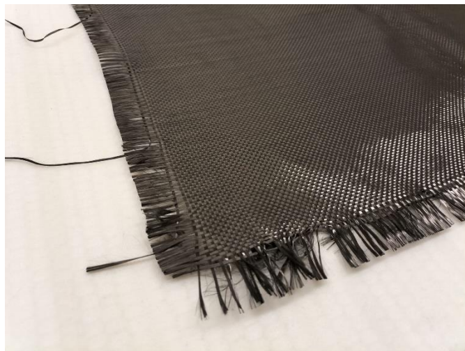
Figura 1 - Tecido em fibra de carbono, utilizado para criação de materiais compósitos
