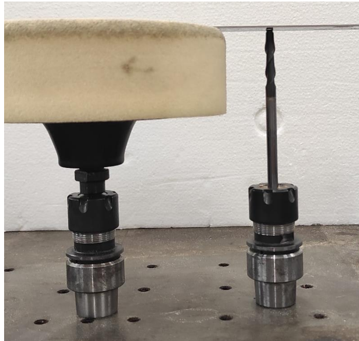
Figura 38: Fresa utilizada para definir o TCP do disco de polimento.
