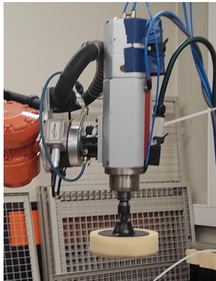
Figura 26: Ferramenta de polimento adaptada para a análise experimental
