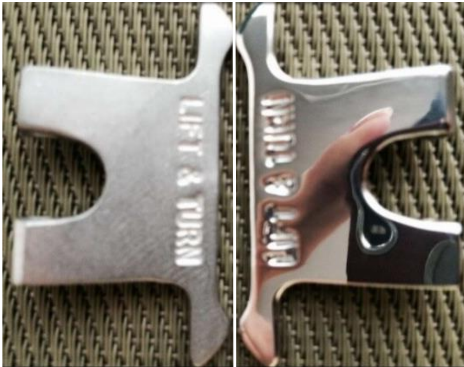
Figura 3: Exemplo de uma peça metálica antes de ser polida (esquerda) e depois de polida (direita).
