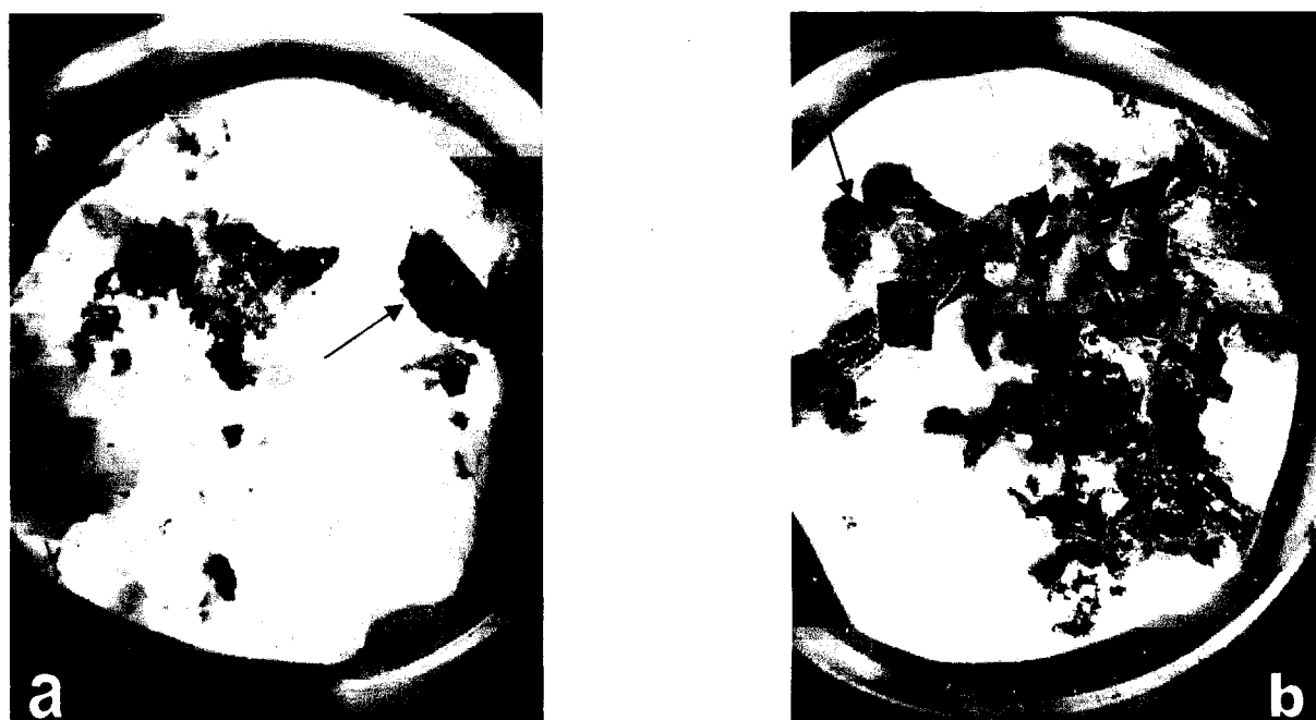
Figura 2. 12 – Superfícies polidas de minério da mina do Borrageiro, com cristais de volframite em a) e cristais de cassiterite em b) numa ganga de quartzo leitoso.
