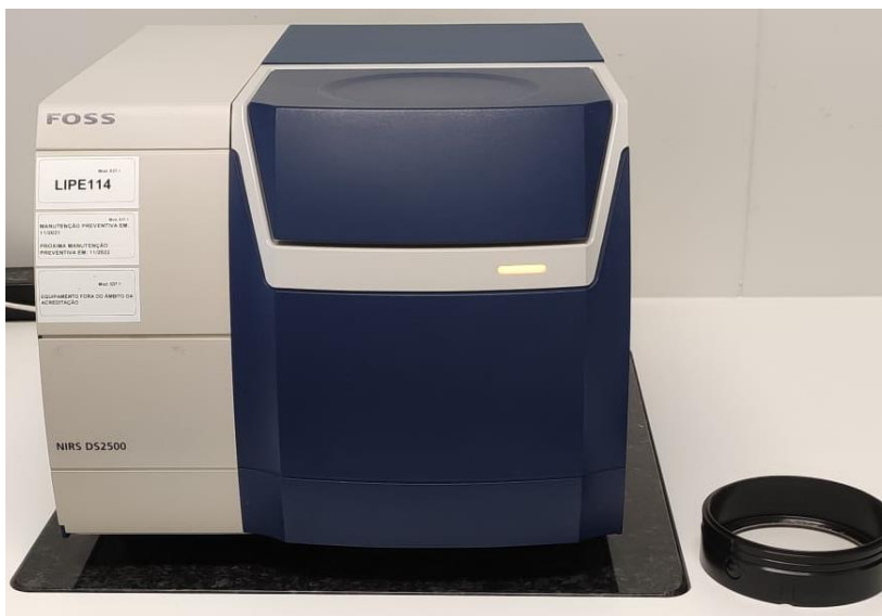
Figura 9. Equipamento FOSS NIR5 TM DS2500 utilizado para obtenção de espectros NIR juntamente com o copo de grande dimensão.
