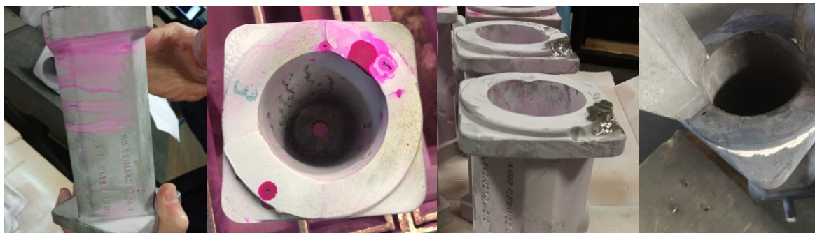
Figuras 29, 30, 31 e 32: Defeitos detetados por líquidos penetrantes nas paredes da peça V (esquerda) e nos alimentadores (restantes)
