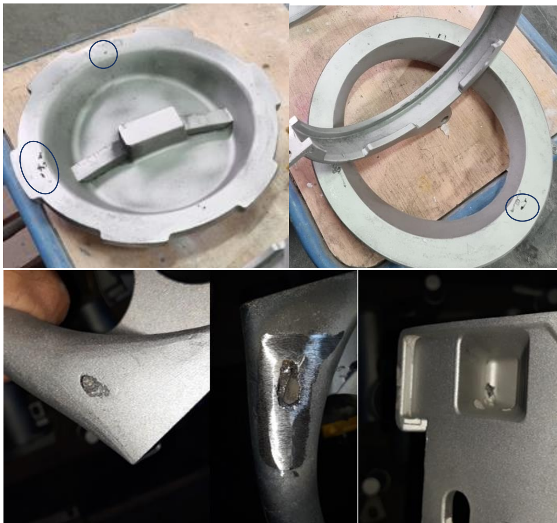
Figura 41: Defeitos verificados nas peças vazadas T, A e M, respectivamente
