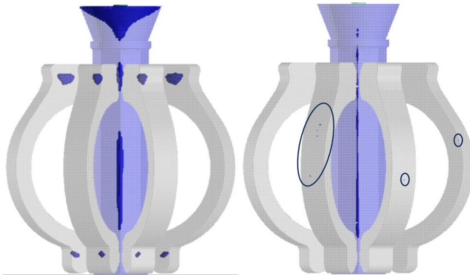
Figura 57: Resultados obtidos de densidade material e critério FCC para a simulação ajustada da peça C
