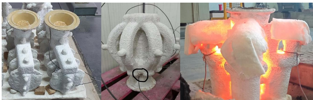
Figuras 9, 10 e 11: Termopares acoplados nas peças D, C e V, respetivamente
