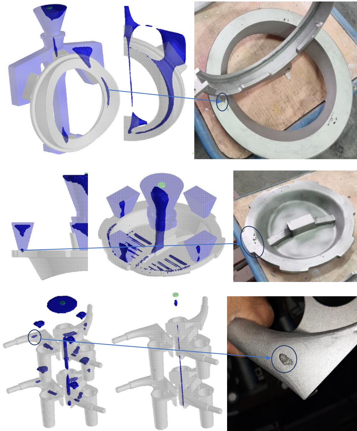
Figura 69: Resultados de densidade material e critério FCC, respectivamente, das peças A, T e M com os parâmetros obtidos pela análise da peça C
