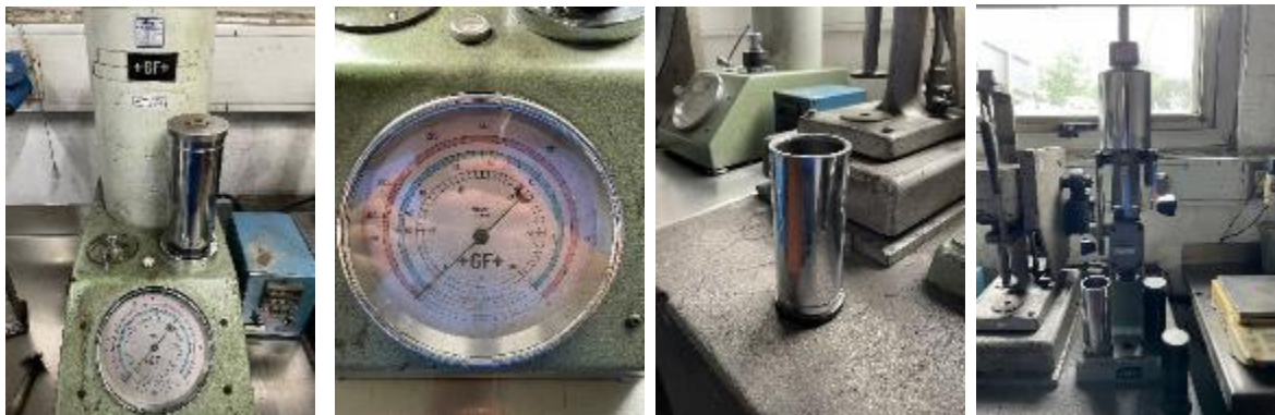
Figura 19 - (a) Aparelho de medição de permeabilidade e respetivo mostrador (b);(c) Molde cilíndrico; (d) Compactador.
