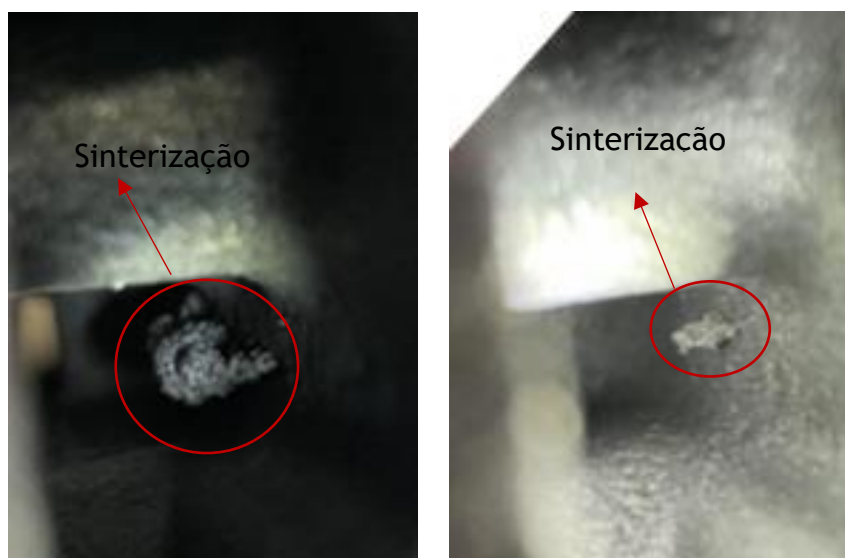
Figura 30- Interior da cavidade da peça obtida através de um macho fabricado pela mistura C45 à esquerda e mistura C55 à direita. Assinalado a vermelho indica-se a presença de defeito de sinterização.
