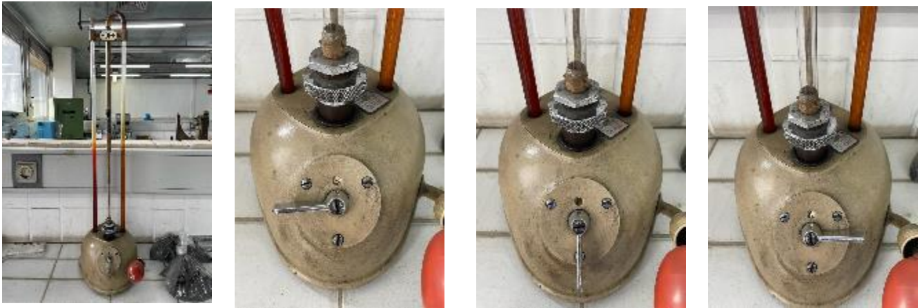
Figura 14 - (a) Aparelho de medição de superfície específica real na posição: (b) de aspiração (c) de repouso e (d) de serviço, respetivamente.
