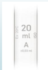
FIGURA 11: INSCRIÇÕES NUMA PIPETA VOLUMÉTRICA.
