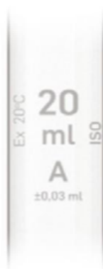
FIGURA 11: INSCRIÇÕES NUMA PIPETA VOLUMÉTRICA.
