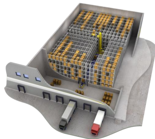
Figura 16 - Estantes de Armazém Automático
