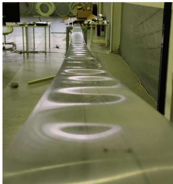
Figura 3.14 – Imperfeições das secções transversais do troço curvilíneo
