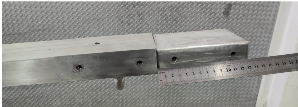
Figura 3.8 – Peça de ligação dos dois troços da barra
