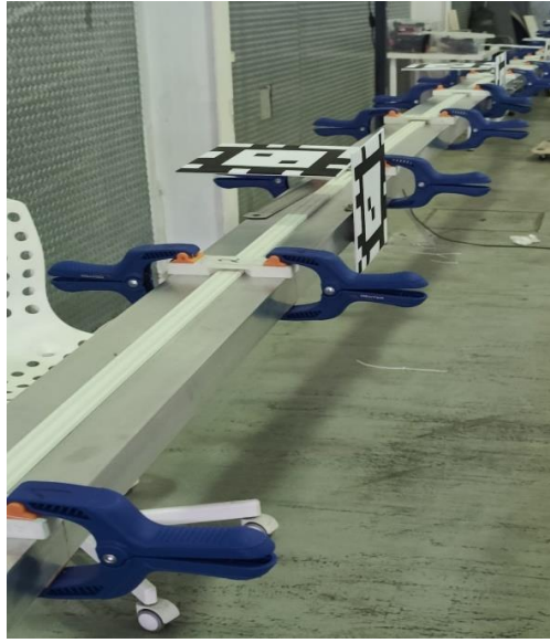
Figura 3.19 – Sensor ótico com suportes e alvos de imagem
