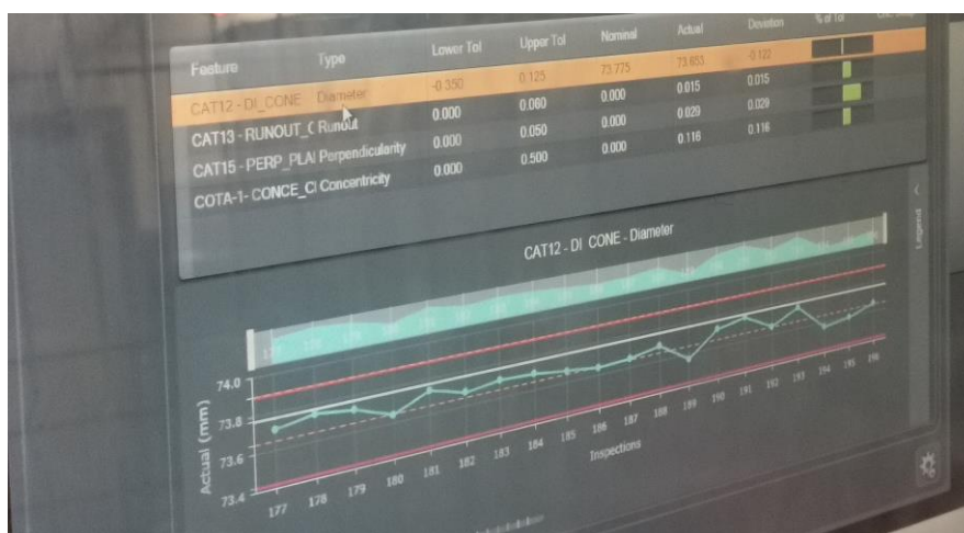
Figura 10: Gráfico produzido pelo Equator para a característica CAT12, com limites de especificação a vermelho
