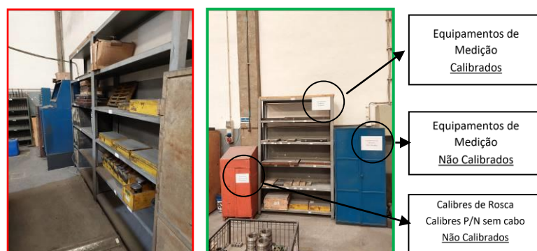
Figura 38 - Arrumação de equipamentos de medição: [A] Antes; [B] Atualmente
