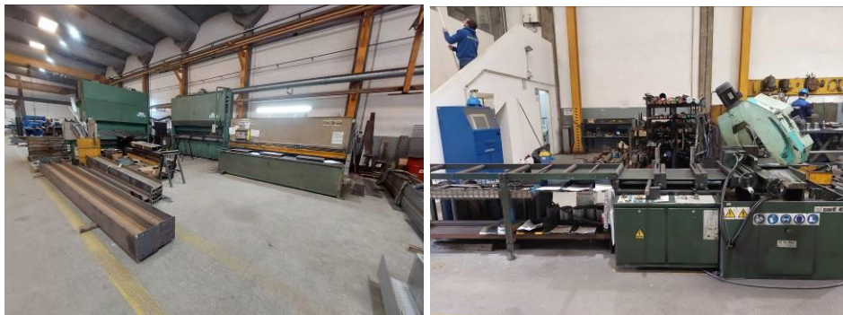
Figura 17 - Secção de Corte e Quinagem
