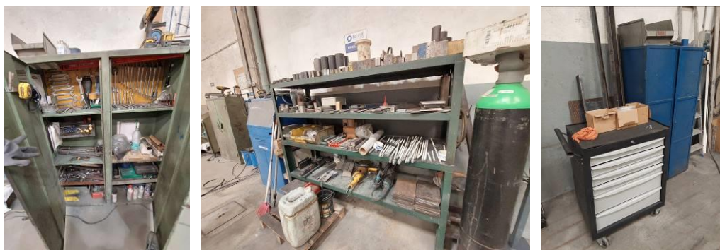
Figura 26 – Ferramentas e acessórios da montagem [A] Armário com ferramentas; [B] Estante com acessórios e equipamentos; [C] Carrinho de ferramentas
