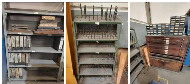
Figura 22 - Zona dos equipamentos CNC: [A] Equipamentos de medição (paquímetros e micrómetros) e documentação CNC; [B] Estante com brocas; [C] Móvel de madeira danificado;
