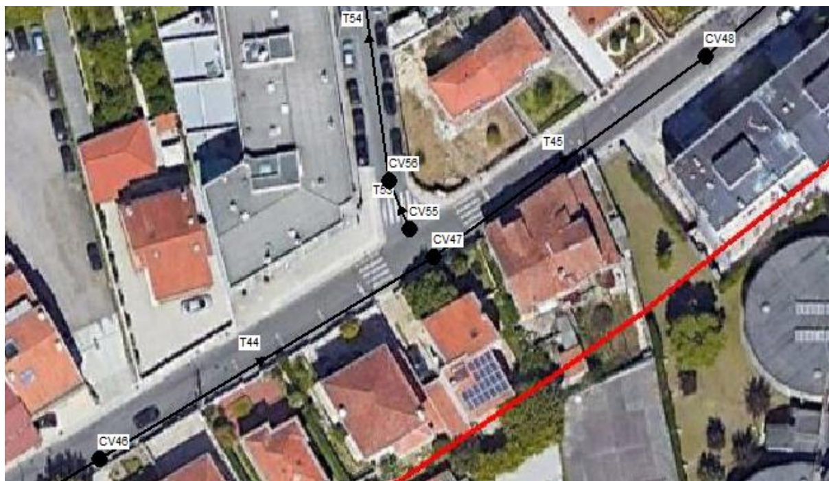
Figura 27 - Identificação das condutas T44 e T45, com problemas de Autolimpeza, no SWMM
