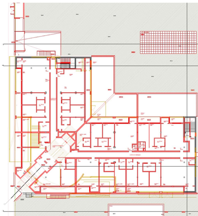
Fig. 3.6: Projeto de demolições e construções R/C
