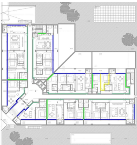
Fig. 3.9. Planta exemplo do condicionamento acústico do edifício em questão
