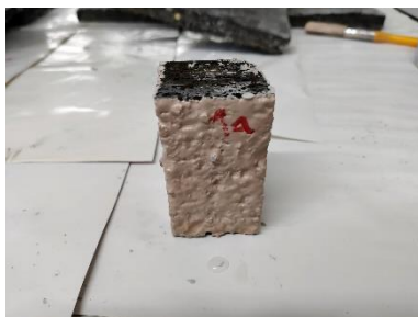
Figura 3.24. – Estado dos provetes após revestimento com impermeabilizante
