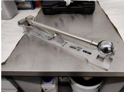
Figura 3.32. – Corpo pendular usado no ensaio (equipamento Mariné Baronnie )
