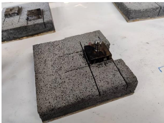
Figura 3.30. – Argamassa após colagem da pastilha metálica
