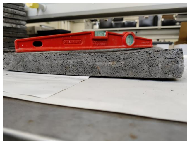
Figura 3.13. – Estado da formulação 2 após condicionamento na estufa
