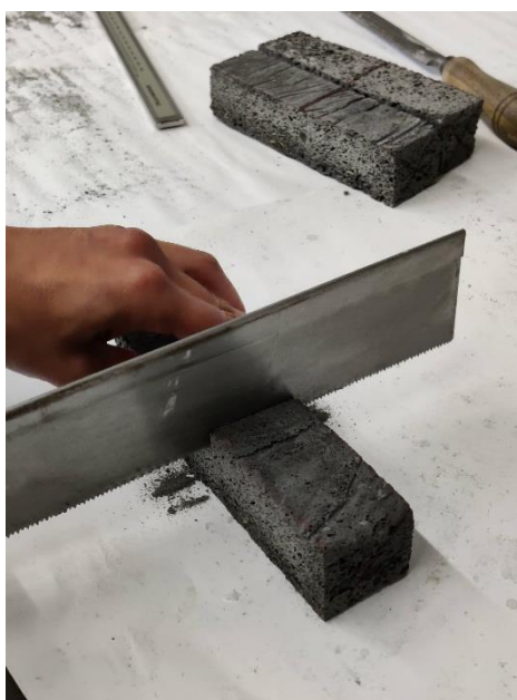
Figura 3.15. – Preparação dos provetes para o ensaio de absorção de água por capilaridade
