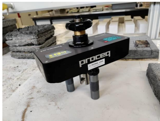
Figura 3.29. – Equipamento de ensaio Proceq DY-216
