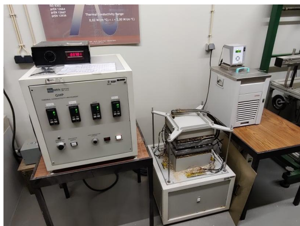
Figura 3.18. – Equipamento de medição da condutibilidade térmica pelo método da placa quente
