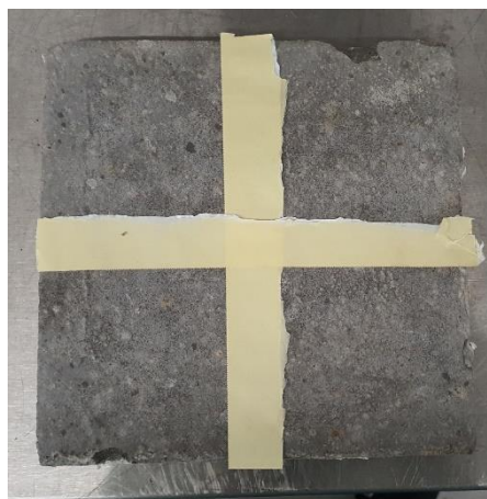
Figura 30 - Reboco exterior do SIP com fita adesiva a dividir em 4 secções
