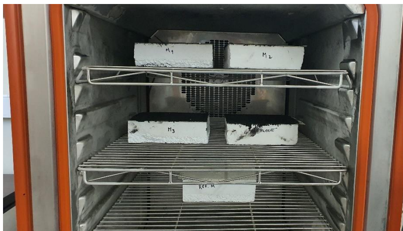
Figura 60 - ETICS colocado na câmara climática
