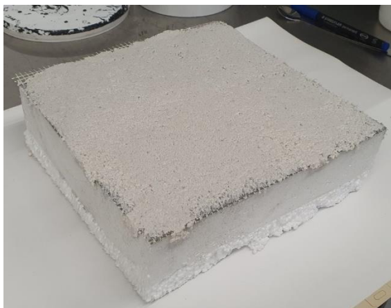
Figura 15 - Aspecto do ETICS com revestimento orgânico barrado
