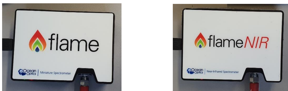
Figura 33 – Espectrofotómetro FLAME (à esquerda); Espectrofotómetro FLAME-NIR (à direita)
