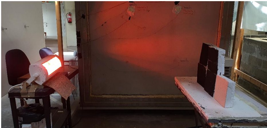
Figura 59 - Lâmpada ligada a aproximadamente 1,60 metros de distância do ETICS
