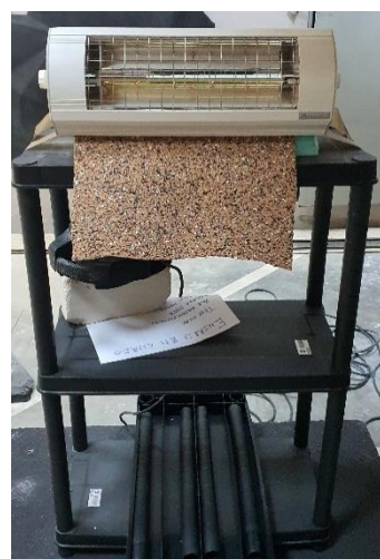
Figura 58 - ETICS em posição vertical (à esquerda); Suporte da lâmpada de infravermelhos (à direita)
