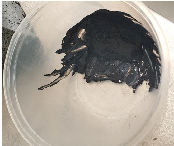
Figura 28 - Aspeto da mistura das nanopartículas com a tinta acrílica
