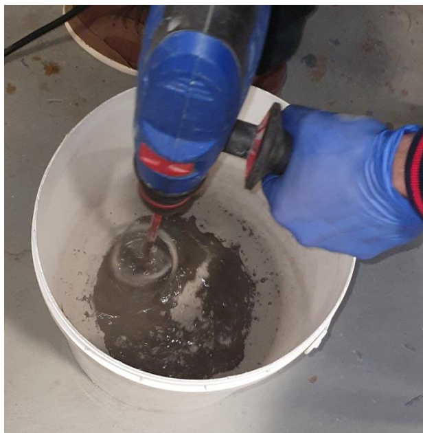
Figura 18 - Mistura dos constituintes do núcleo do SIP
