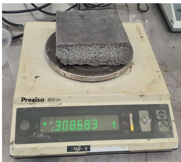
Figura 24 - Pesagem da argamassa do núcleo do SIP/painel de fachada ventilada sem revestimento
