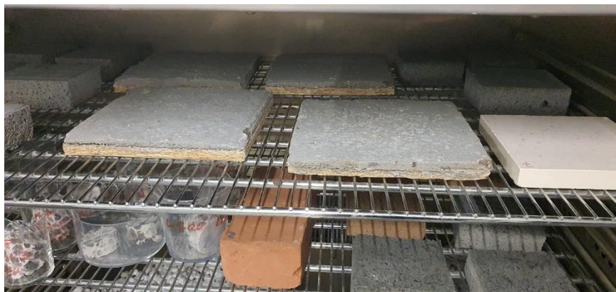
Figura 22 - Amostras do núcleo e reboco exterior do SIP na estufa
