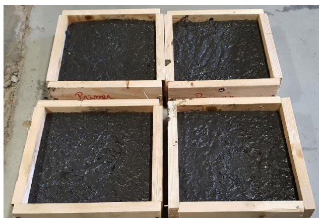
Figura 19 - Enchimento dos moldes que vão dar origem às amostras do núcleo do SIP para posteriores ensaios dos efeitos das nanopartículas nas propriedades superficiais e no comportamento higrotérmico
