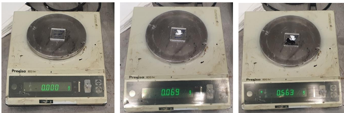
Figura 9 – Balança tarada após colocação da placa de acrílico (à esquerda); Pesagem das nanopartículas (ao centro); Pesagem da tinta acrílica ou colorante (à direita)
