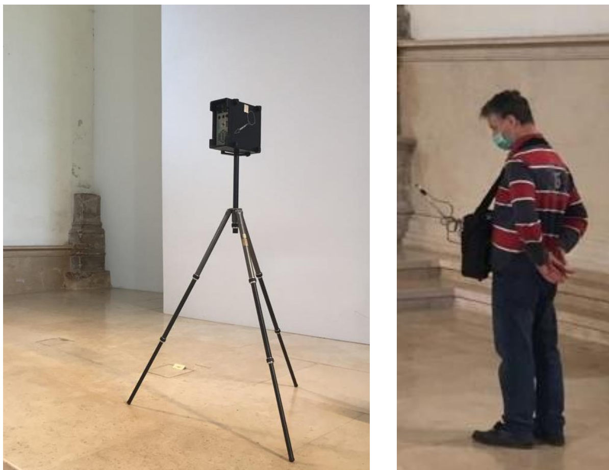
Fig. 5.11 -Fonte sonora RASTI B&K 4225 (esq.), recetor B&K 4419 e medição do RASTI (dir.) [fotos do autor]
