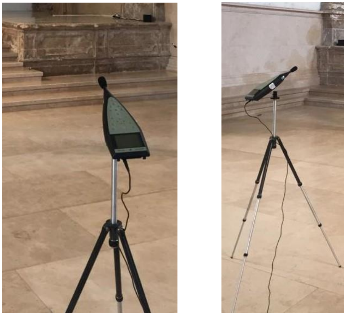
Fig. 5.7 - Sonómetro Brüel & Kjør, modelo 2260 [fotos do autor]
