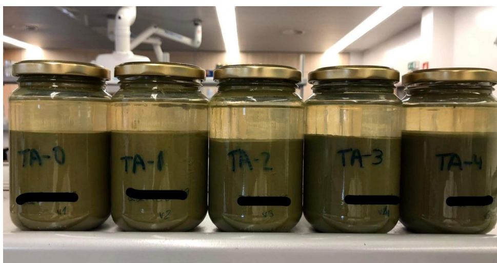
Figura 21 - Separação de fases nas amostras das várias versões do primário epóxi após o ensaio de estabilidade acelerada
