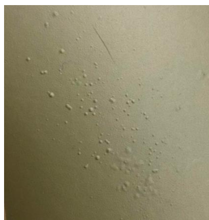
Figura 22 - Empolamento 2(S2) numa zona da placa (fotografia com ampliação).
