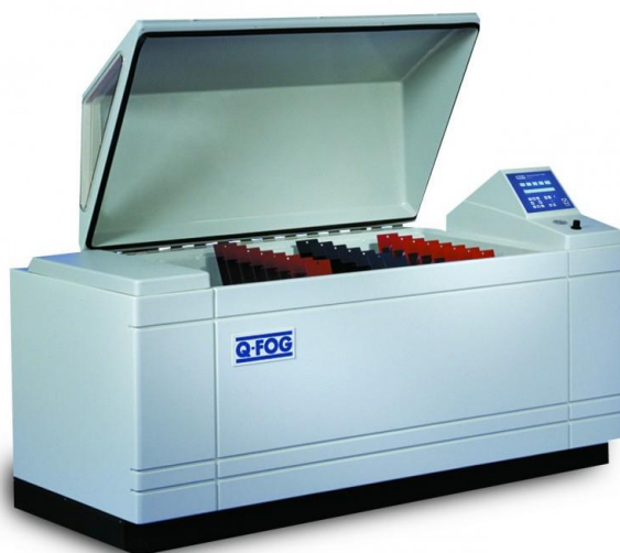
Figura 12 - Aparelho de nevoeiro salino [27] .
