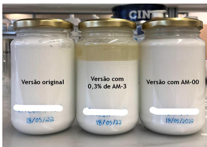
Figura 26 - Aspeto das amostras das três versões da base brilhante após o ensaio de estabilidade acelerada.
