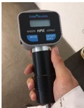
Figura 9. Fotografia do medidor de dureza de Barcol utilizado - modelo HPE da Bareiss®.
