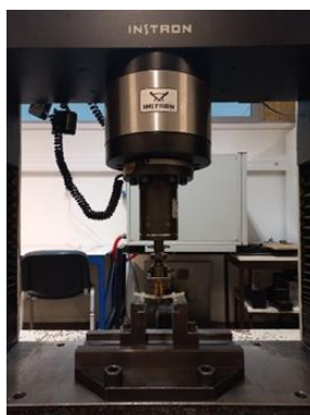
Figura 16. Fotografia do equipamento utilizado nos ensaios de flexão.
