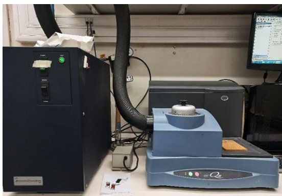
Figura 12. Fotografia do equipamento utilizado nos ensaios de DSC - Modelo Q20 da TA Instruments®.
