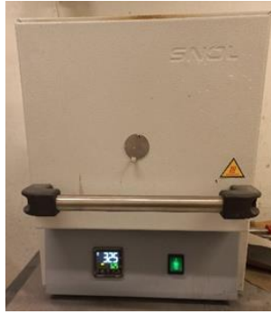
Figura 11. Fotografia da mufla utilizada nos ensaios de teor de fibras e volume de vazios.
