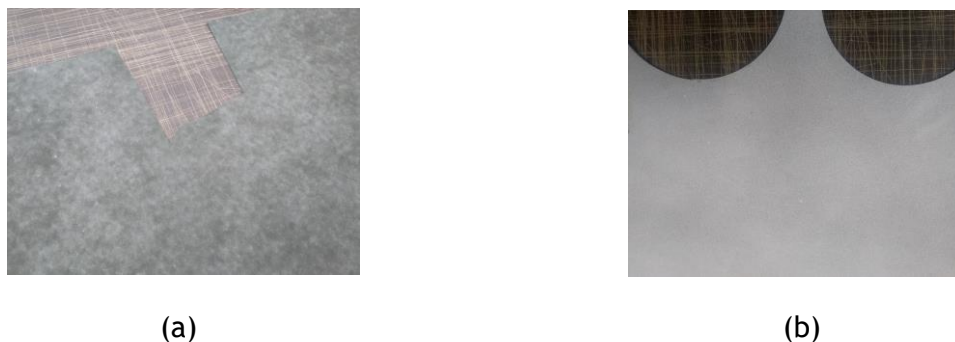
Figura 10 - Papéis kraft preto impregnados com dispersões 20 % (m/m) de slurry + 80 % (m/m) de água (a) e 90 % (m/m) de slurry + 10 % (m/m) de água (b).
