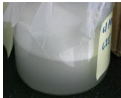
Figura A.10 - Separação de fase observada no caso do Mikrathermic C28 (wet cake).
