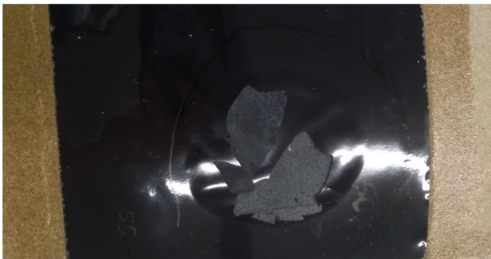
Figura A.13 - Camada interna da bolha formada entre a primeira folha de papel kraft e o papel decorativo durante o ensaio de resistência ao calor seco para o laminado com 3 % (m/m) de PCM microencapsulados.
