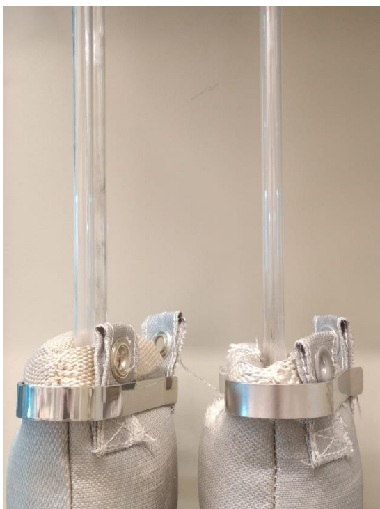
Figura 10 – Etapa de degaseificação das amostras de biocarvão para obtenção das isotérmicas de adsorção-desorção em N_2 .
