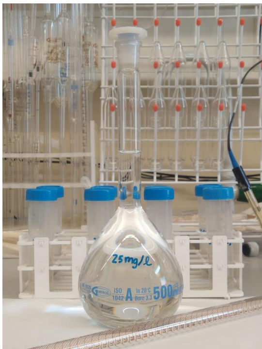
Figura 8 – Solução de P utilizada para os ensaios de adsorção com os biocarvões do Desenho Experimental.
