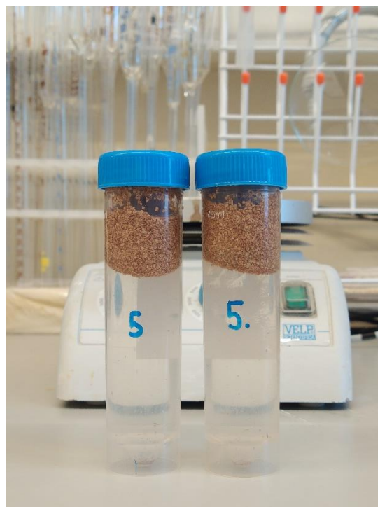
Figura 5 – Tubos Falcon com cortiça em solução de \text{MgCl}_2 ( 2,3 \text{ mol} \cdot \text{L}^{-1} ), após 24 h em agitador rotativo.
