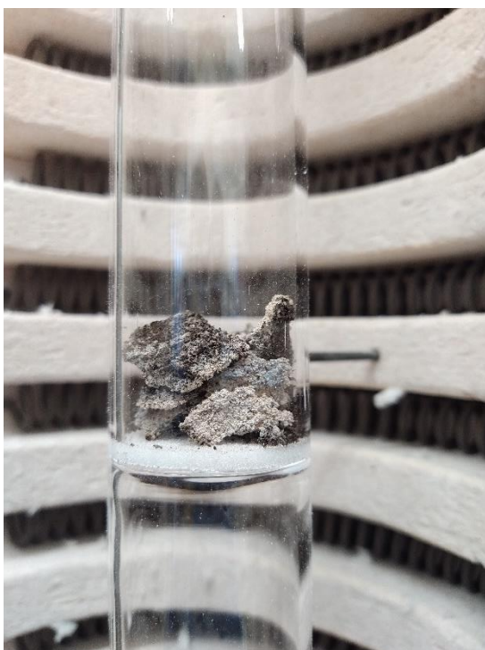
Figura 6 – Material resultante do tratamento térmico de uma amostra do Ensaio 3, em atmosfera de \text{N}_2 e a uma temperatura de 350^\circ\text{C} .
