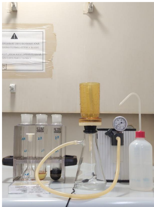
Figura 9 – Filtração em vácuo após digestão ácida das amostras de biocarvão.
