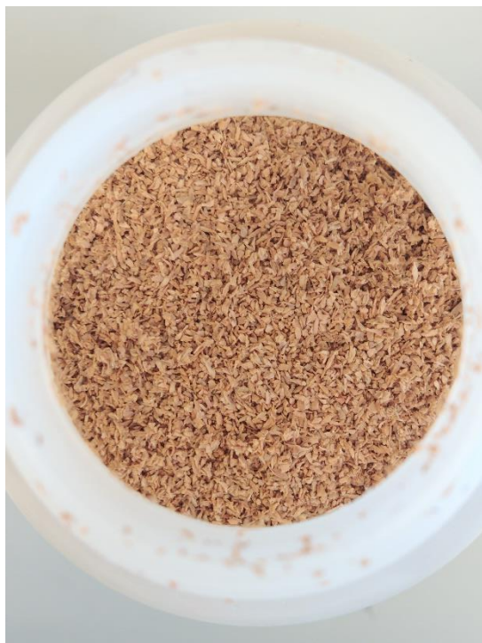
Figura 4 – Grânulos de cortiça seca e lavada, utilizados na síntese dos biocarvões.
