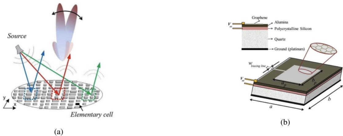
Figura 2.8: Antena do tipo reflect-array (a) e célula primária em grafeno (b) retirada de [7]
