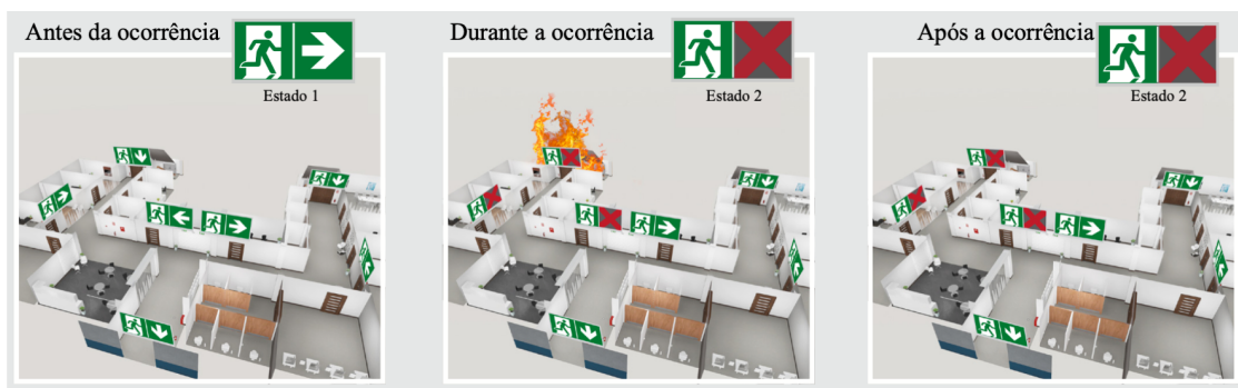
Figura 3.2: Exemplo de funcionamento de sistema de luminárias do tipo dinâmico [1].
