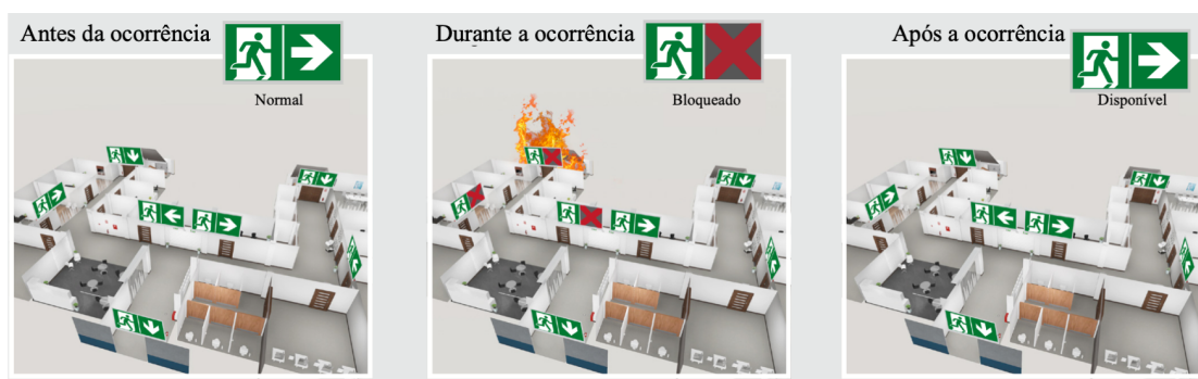
Figura 3.3: Exemplo de funcionamento de sistema de luminárias do tipo adaptável [1].
