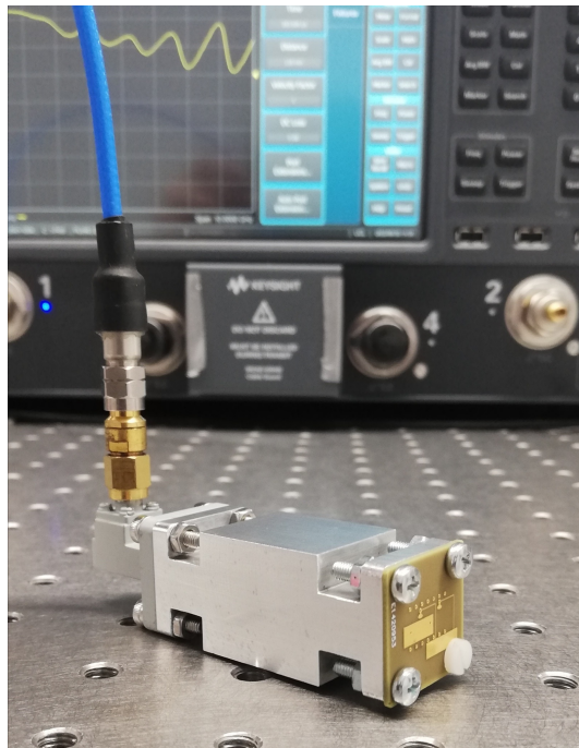
Figura 4.42: Configuração da caracterização experimental de duas células adjacentes com ênfase no guia de onda e respetivo adaptador com a PCB fixada na cavidade
