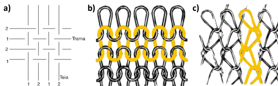
Figura 7. Estrutura de tecido a), de malha de trama b) e de malha teia c). (Gomes et al., 2005)
