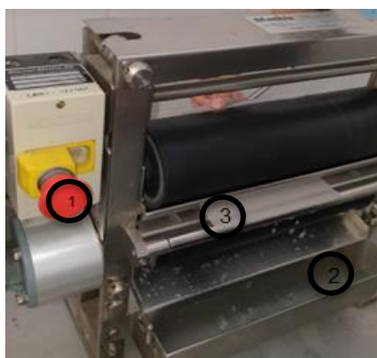
Figura 31- Fotografia do processo de passagem do tecido têxtil em produto na máquina Foulard .
