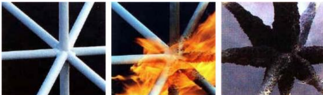
Figura 22 - Reação da tinta intumescente, adaptado de [59].
