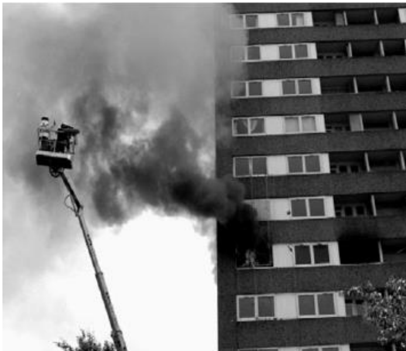
Figura 21 - Testes de fogo de Dalmarnock, adaptado de [53].
