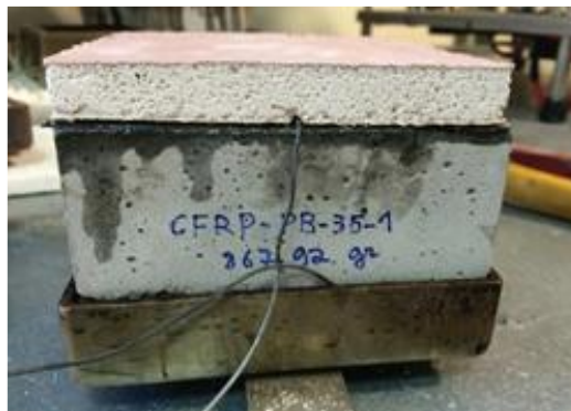
Figura 23 - Provetes protegidos com placa de gesso, adaptado de [52].
