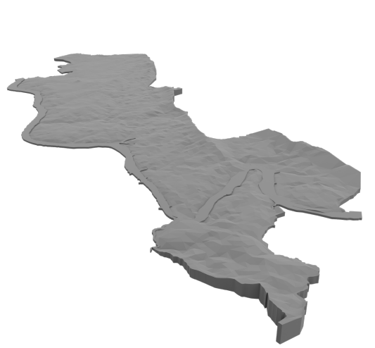
Fig 36 - Modelo Geométrico 3D realizado a partir da nuvem de pontos
