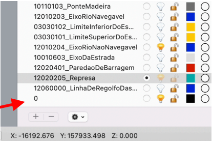
Fig 42 - Layers do modelo geométrico depois de executar o script. Todos os Layers que estavam vazios foram apagados (Como por exemplo o Layer "0")
