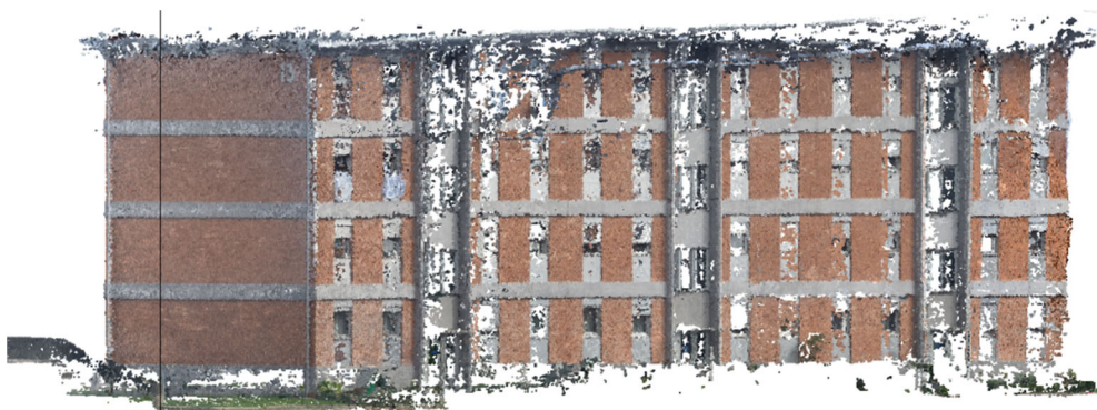
Figura 33 - Nuvem de pontos na vista 3D do Revit
