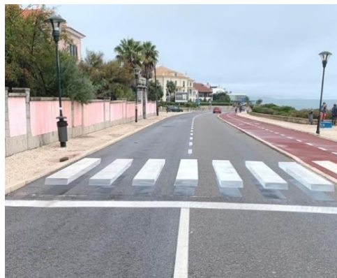
Fig.32- Passadeira 3D em Cascais
