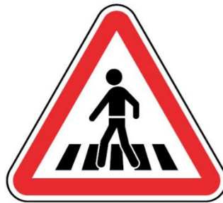
Fig.19- Sinal de perigo na chegada a uma passadeira
