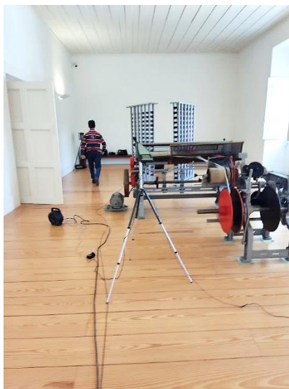
Fig. 4.11 – Preparações iniciais da instalação dos cabos e da posição dos diversos equipamentos de medição [Foto da autora]
