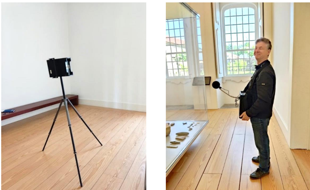
Fig. 4.14 – Fonte Sonora RASTI Brüel & Kjaer modelo 4225 (esq.) e Eng o . António Eduardo Costa com o recetor Brüel & Kjaer modelo 4419 (dir.) [Fotos da autora]
