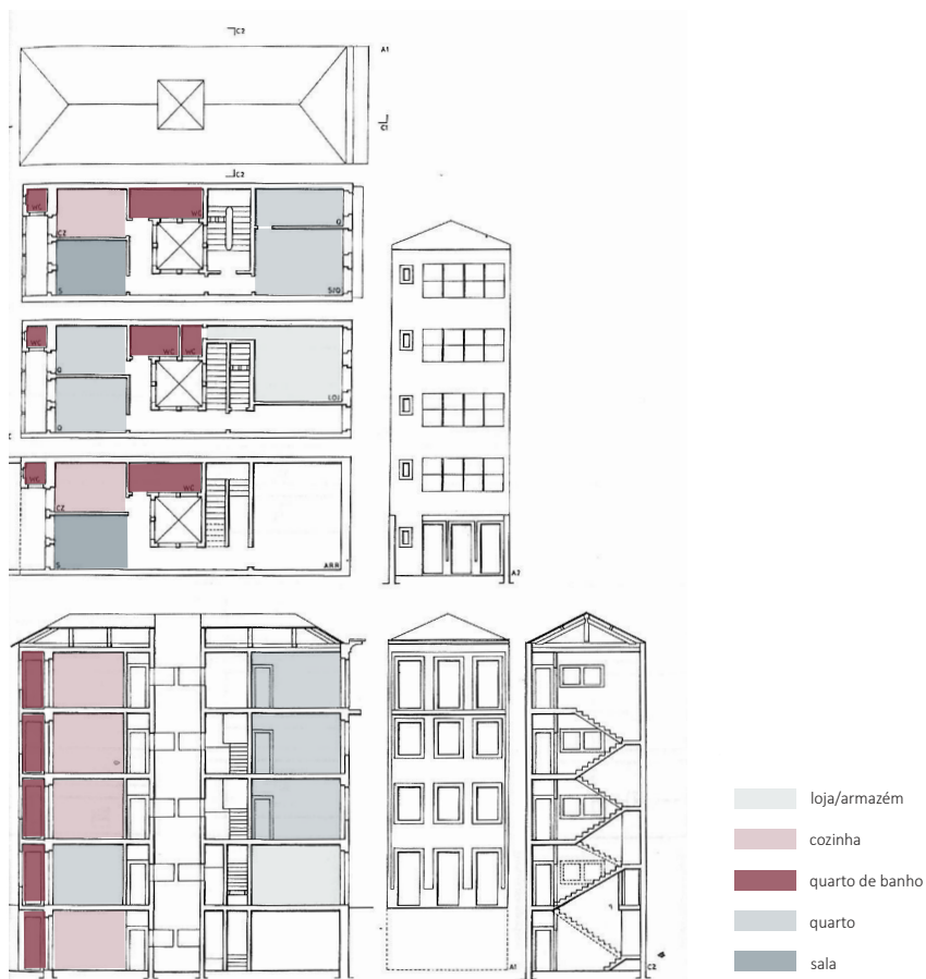
43. Adaptação de um edifício unifamiliar para plurifamiliar
