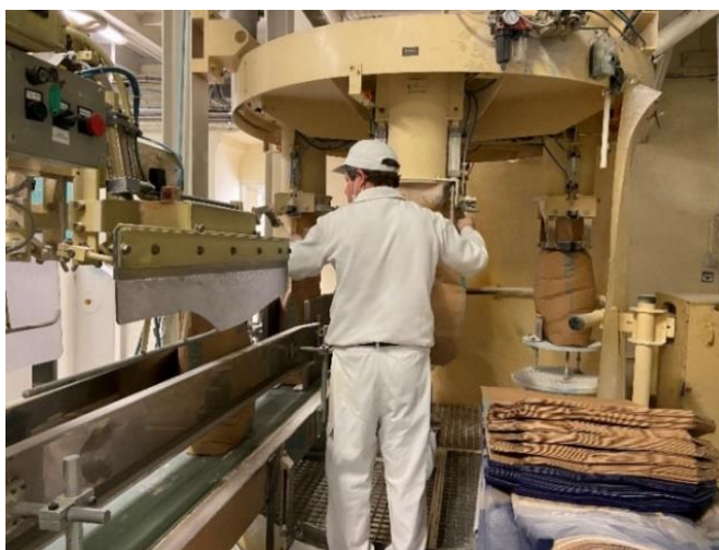
Figura 16: Zona de ensaque de farinha para usos industriais- Farinha Simples
