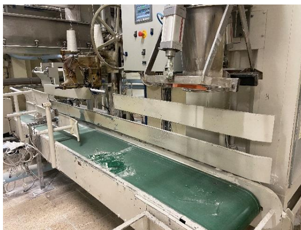
Figura 17: Zona de ensaque de farinha para usos industriais- Farinha Aditivada
