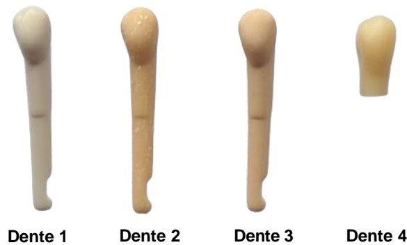
Figura 1- Dentes utilizados no estudo: Dente 1- KaVo®; Dente 2- NextDent®, cor pêssego; Dente 3- Asiga®, cor amêndoa; Dente 4- PMMA, cor A3.
