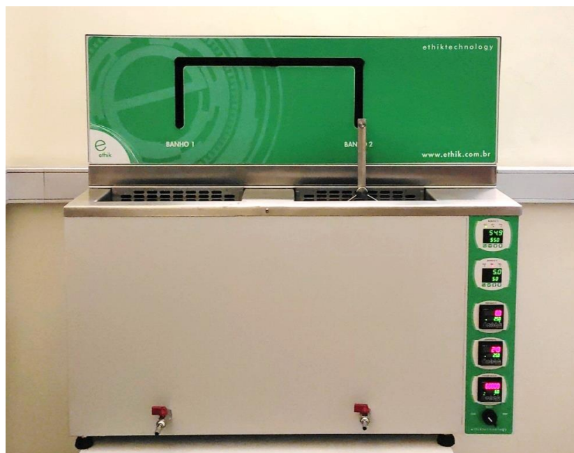
FIGURA 6. TERMOCICLADORA ETHIKTECHNOLOGY (MODELO 621-1D, POTÊNCIA: 3200W, TENSÃO: 220V 50HZ): FACULDADE DE MEDICINA DENTÁRIA DA UNIVERSIDADE DO PORTO.
