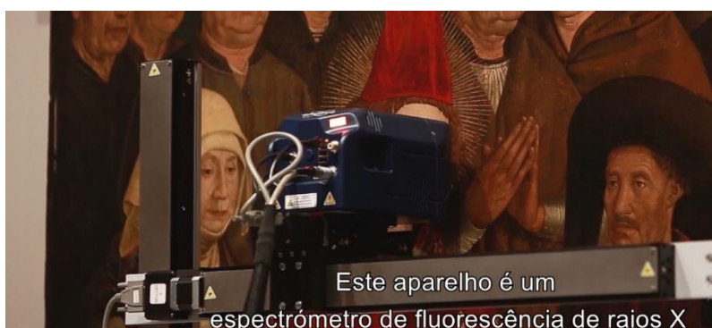
Figura 62 Vídeo que mostra o aparelho que permite utilizar a técnica Fluorescência de Raios X (XRF) a analisar os Painéis de São Vicente. Público. [00:00:04].
