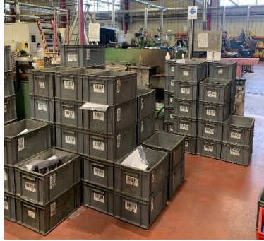
Figura 3.2 – Acumulação desordenada de caixas junto do operador da equilibragem
