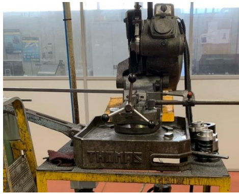
Figura 3.8 - Máquina SR4, destinada a corte de calços
